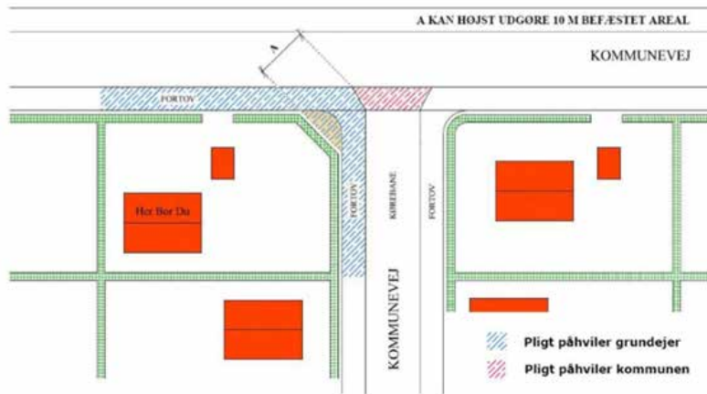
Figur 7 Som figur 6 hvor hjørnet ikke er beplantet men udført i anden belægning end selve fortovet, fx befæstet med grus. Her påhviler pligten for hele hjørnet grundejeren, også selv om der er tale om anden belægning end fortovet, såfremt kommunen betragter og administrerer den pågældende del af vejen som et areal, der fortrinsvist er forbeholdt gående færdsel.
